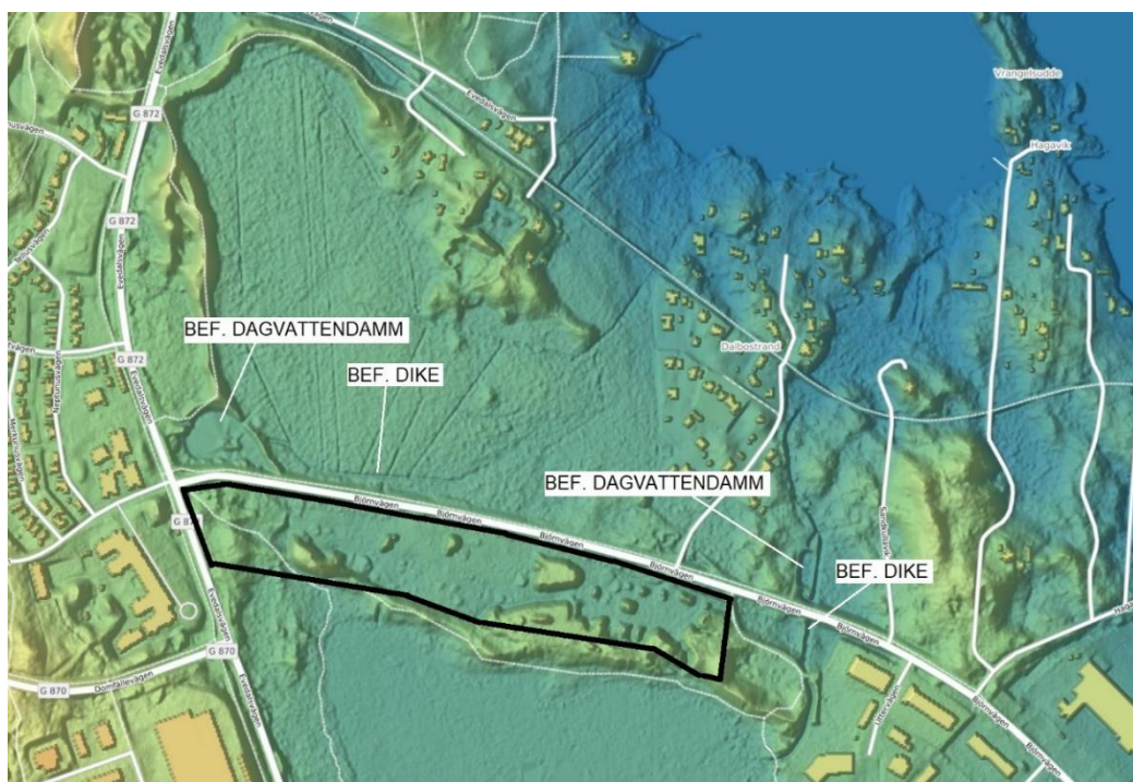
Figur 2 Här visas befintliga dagvattensystem som är aktuella för utredningsområdet. Detaljplanens ungefärliga exploateringsområde är markerat med polygon.
